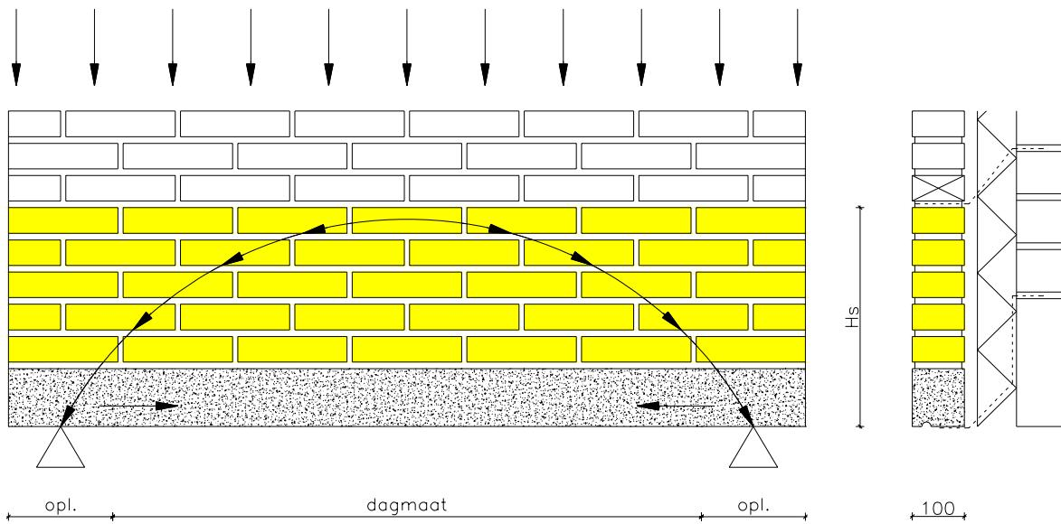
Doordat het benodigde aantal lagen metselwerk (Hs) niet mag worden onderbroken, kunnen in dit gebied geen lateislatten, sparingen en open stootvoegen worden aangebracht.
